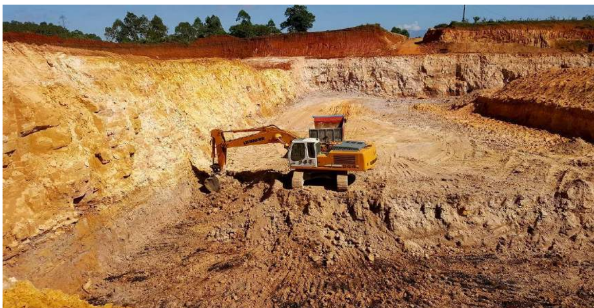
Figura 9: Remoção do banco de arenitos e do siltito de cobertura da camada de carvão Barro Branco.
