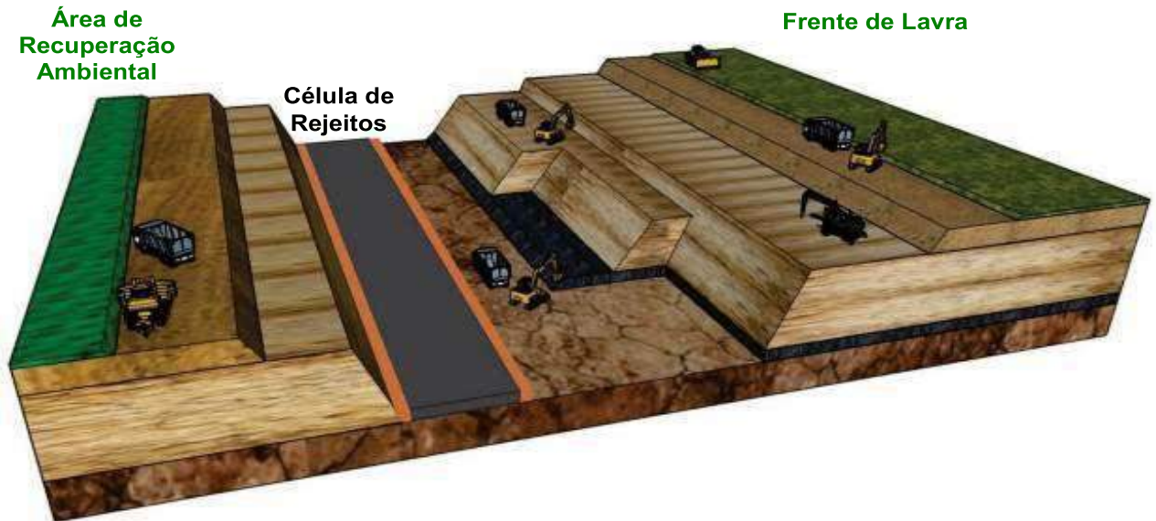
Figura 3: Esquema de lavra a céu aberto pelo método denominado "stripping mining", com recuperação ambiental simultânea à lavra.
